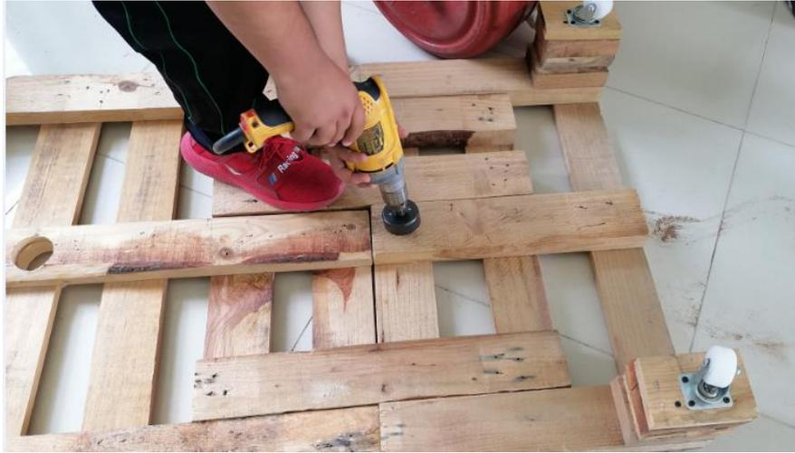
Hasta el momento se muestra cómo se resolvió el problema de almacenamiento de la materia orgánica y la movilidad, sin embargo, aún era necesario instalar un sistema profundo de drenado, pero sin perder de vista un sistema ergonómico y de fácil instalación es por eso que se instaló un sistema de vaciado total de la materia orgánica por debajo de la base con ayuda de tuercas unión las cuales permiten desensamblar el biodigestor totalmente.
