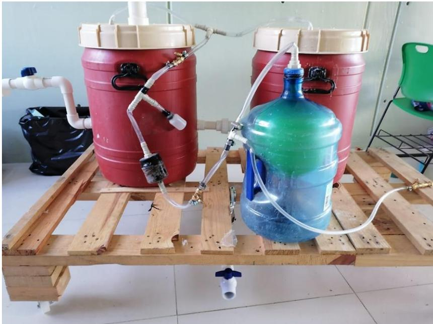
Una vez instalada la línea de conducción de gas se llevó a cabo el llenado de digester, para el cual se preparó una mezcla de 10% hojarasca, 2% aceite vegetal y una relación 1:1 de estiércol vacuno y agua.
